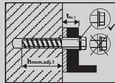
4. Nach dem Anbringen der Unterfütterung erfolgt erneute Befestigung des Anbauteils entsprechend den Montagevorschriften.
