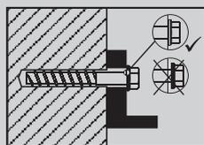
2. Sollte nach der erfolgten Montage zum Ausgleich eine Unterfütterung notwendig sein, ist dies mit den Betonschrauben BSZ (Ø 8 – 14mm) um bis zu 10 mm möglich.
