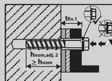
6. Nach der 2. Unterfütterung erfolgt die erneute Montage des Anbauteils entsprechend den Montagevorschriften.
